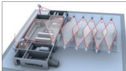
Die Überwachung einer Tankstelle gliedert sich in verschiedene Bereiche, welche unterschiedliche Anforderungen an eingesetzte Kameras stellen. Zum Einsatz kommen CCTV Kameras plus digitaler Aufzeichnung, die auch über eine Netzwerkverbindung verfügen.
