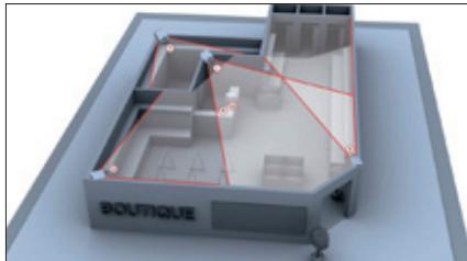
Bei diesem Beispiel kommt das SANTEC SDD-Ein-Kabel Kamera System zum Einsatz. Damit lässt sich sehr einfach, schnell und kostengünstig eine Videoüberwachungsanlage installieren. Über das SDD Systemkabel erfolgt die Bildübertragung und die Spannungsversorgung. Das SDD-Netzteil versorgt bis zu 4 Kameras mit der Betriebsspannung.
